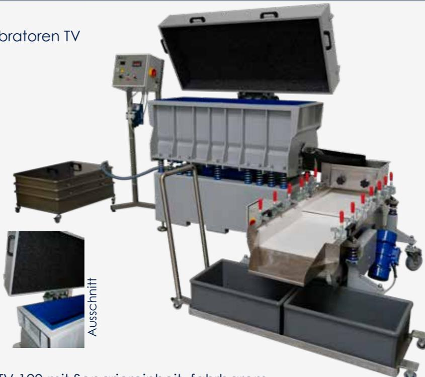
TV 120 mit Separiereinheit, fahrbarem Mediacontainer und Kaskade zur Abwasserreinigung
